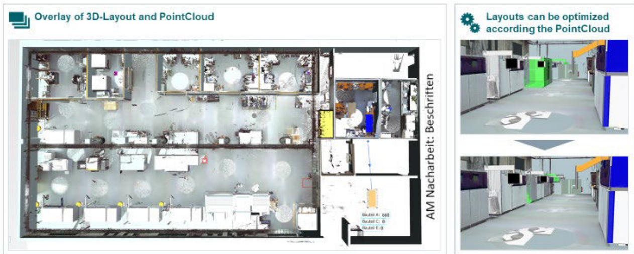
Abbildung 142: Überlagerung von 3D-Layout und aufgezeichneter Punktwolke in der Draufsicht (links) sowie in der virtuellen 3D-Begehung
