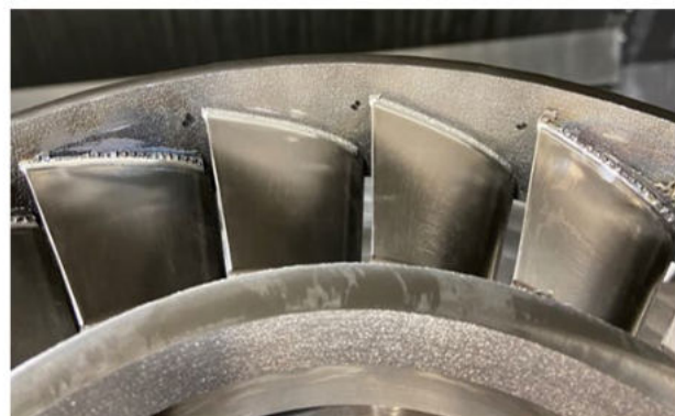
Abbildung 105: Links: Fläche nach Entfernung der Konturen mittels Fräsen; Rechts: Fläche nach Abtrag des Aufmaßes mittels Zerspanung (Schruppe, Schlicht- und Feinschlichten)
