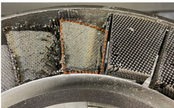
Abbildung 105: Links: Fläche nach Entfernung der Konturen mittels Fräsen; Rechts: Fläche nach Abtrag des Aufmaßes mittels Zerspanung (Schruppe, Schlicht- und Feinschlichten)
