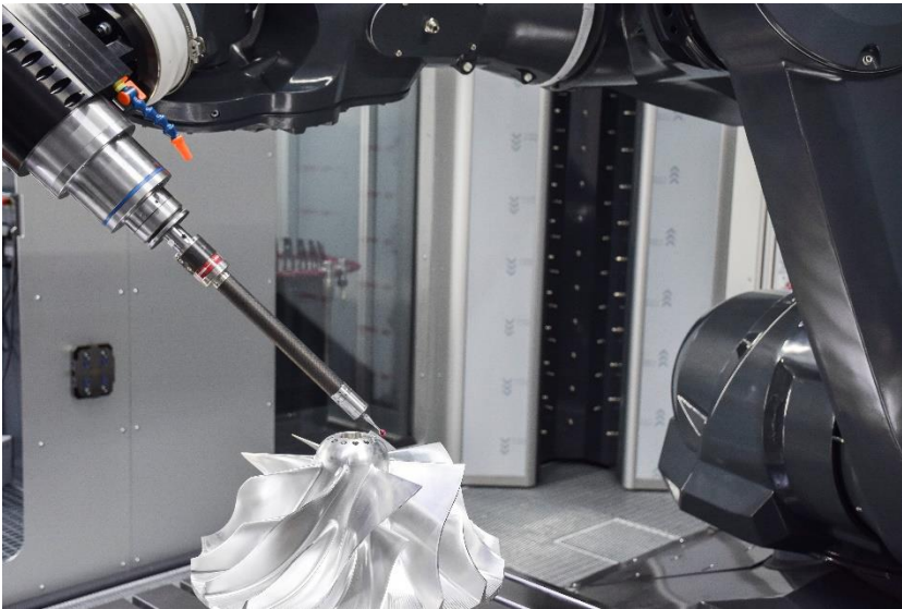
Bild 6: Automatisiertes Messen in der Roboterzelle – nur so lässt sich die Qualität in der Originalaufspannung rund um die Uhr mannos sicherstellen.
