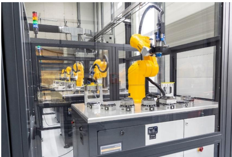
Bild 1: Fünf Staubli-Roboter polieren Keramikspangen für Gangwahlhebel. Die Präzision der Bearbeitung wird durch die Werkzeuglängenmessung mit dem Werkzeug-Messtaster Z-Nano von BLUM gewährleistet.
