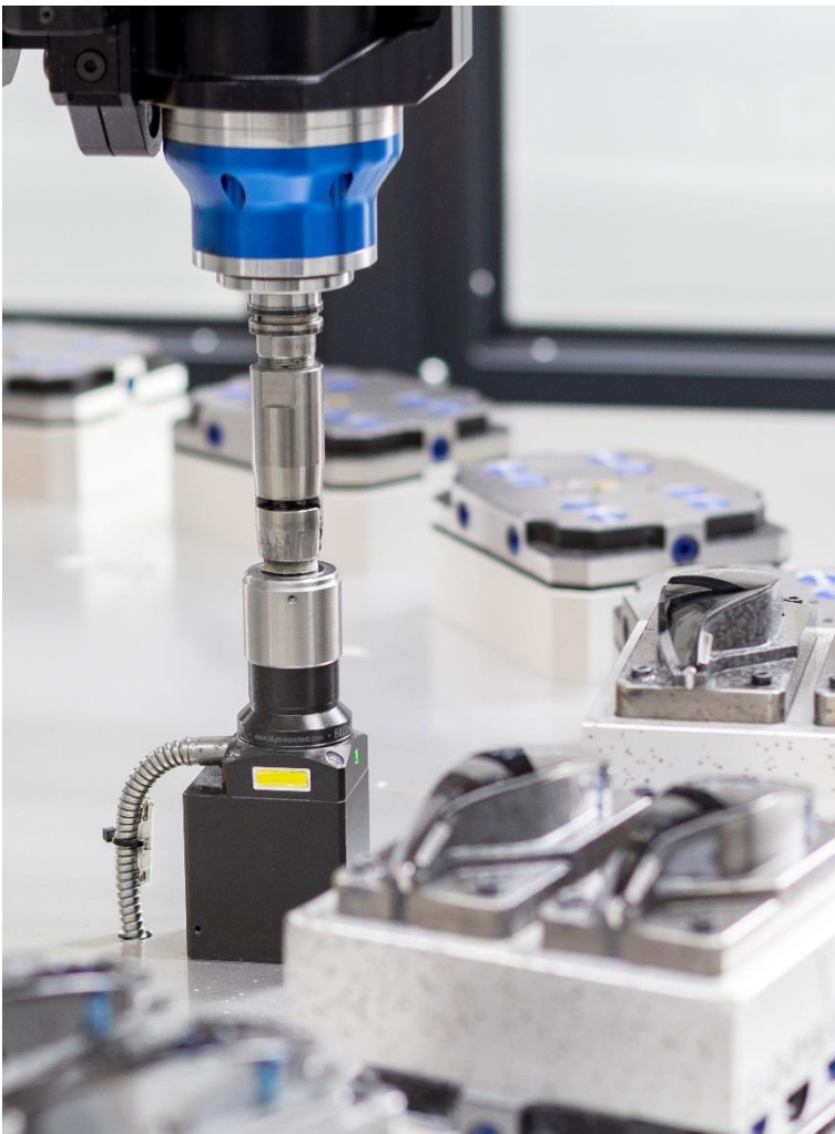
Bild 2: Das Filzwerkzeug nutzt sich schnell ab, deshalb wird vor jedem Poliervorgang mit dem Tastkopf Z-Nano die aktuelle Werkzeuglänge gemessen.
