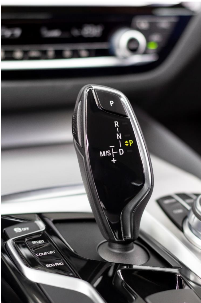
Gangwahlhebel mit Keramikspange
