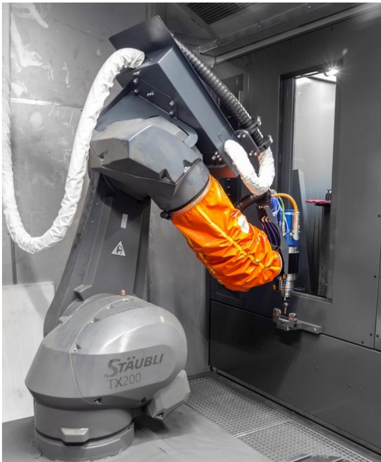
Bild 4: Die Präzision der Fräsbearbeitung mit dem Roboterarm hängt ganz entscheidend von der regelmäßigen Werkzeugmessung mit dem Lasermesssystem von BLUM ab.
